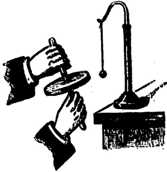
Fig. 43. — Neutralisation des électricités développées par le frottement. Première expérience.
